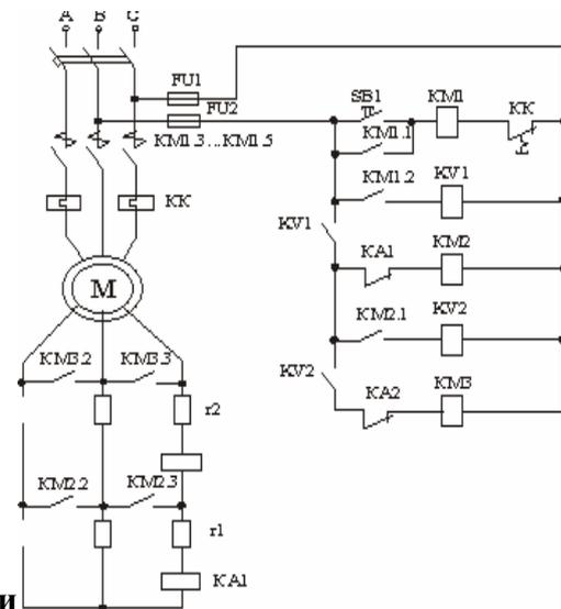
**Пуск асинхронного двигателя производится в функции**
