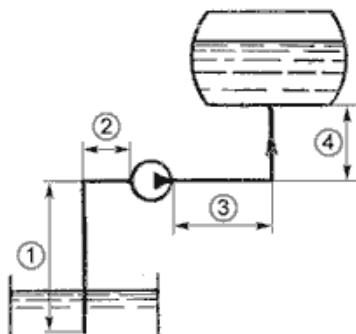
На представленном рисунке всасывающий трубопровод обозначен позицией:
