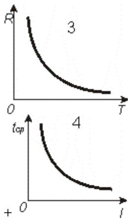
**Какая зависимость времени срабатывания теплового реле от тока?**
