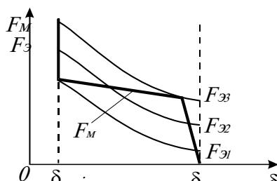
На рисунке показаны семейство тяговых  $F\mathcal{E}=f(d)$  и механическая  $FM = f(d)$  характеристики реле. При какой тяговой характеристике произойдет срабатывание реле?
