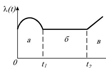
На графической зависимости опасности отказов  $\lambda(t)$  укажите этап приработки:
