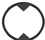
насос с регулируемой подачей и постоянным направлением потока
