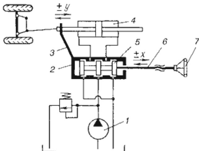
схема гидроусилителя золотникового типа с компенсаторами
