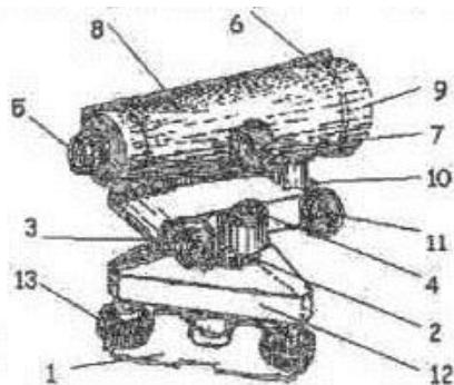
+приведения визирной оси нивелира и оси цилиндрического уровня в горизонтальное положение
