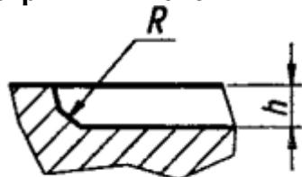
+ на горизонтально-фрезерном станке дисковой фрезой;
