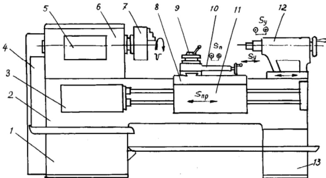
передняя тумба (с электродвигателем главного привода станка);
