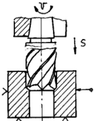
Сверление глухого(сквозного) отверстия спиральным сверлом
