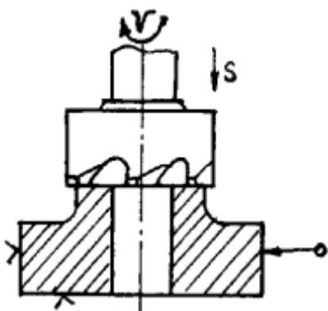
Сверление глухого(сквозного) отверстия спиральным сверлом
