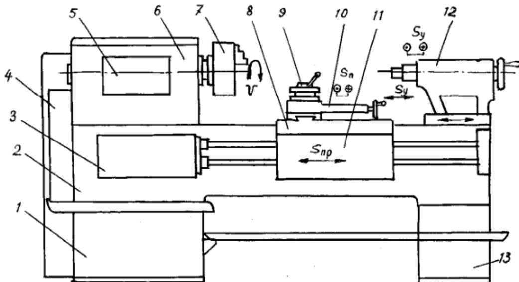
передняя тумба (с электродвигателем главного привода станка);
