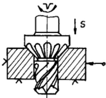
Сверление глухого(сквозного) отверстия спиральным сверлом
