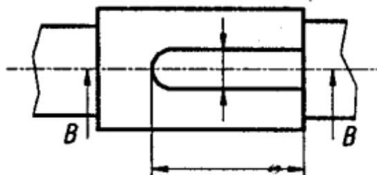
на горизонтально-фрезерном станке дисковой фрезой;
