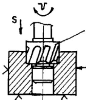
Сверление глухого(сквозного) отверстия спиральным сверлом
