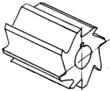
цилиндрическая фреза с прямым зубом;
