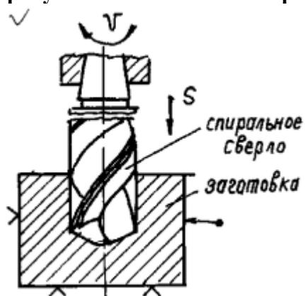
+ Сверление глухого(сквозного) отверстия спиральным сверлом
