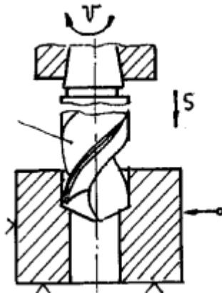
Сверление глухого(сквозного) отверстия спиральным сверлом
