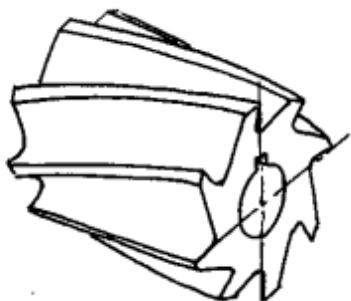
цилиндрическая фреза с прямым зубом;
