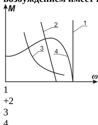
**Недопустимо включать без нагрузки двигатель постоянного тока:**
