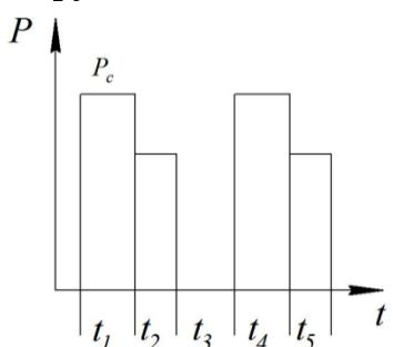
$$\varepsilon = \frac{t_1 + t_2 + t_3}{t_1 + t_2 + t_3 + t_4 + t_5}$$
