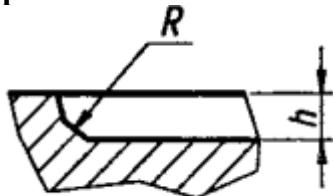
+ на горизонтально-фрезерном станке дисковой фрезой;
