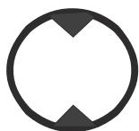
насос с регулируемой подачей и постоянным направлением потока
