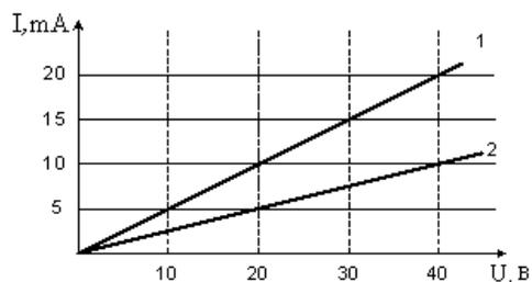
Отношение сопротивлений  $R_1/R_2$  этих элементов равно...
