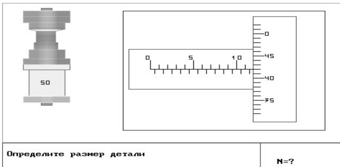
Правильный ответ: 136,92 (размер микрометрического нутромера 75+размер вставки 50 мм.+ показания по шкале 11,92)
