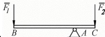
На брус ВС, закрепленный в шарнире А , действуют вертикальные силы  $F_1 = 4 \text{ kH}$  и  $F_2$ . Определить силу  $F_2$  в кН, необходимую для того, чтобы брус в положении равновесия был горизонтальным, если расстояния  $AC = 2 \text{ м}$ ,  $AB = 6 \text{ м}$ .
