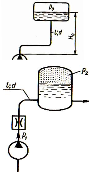
2) Какое давление должен создавать насос при подаче масла  $Q=0,4$  л/с и при давлении воздуха в пневмогидравлическом аккумуляторе  $p_2=2$  МПа, если коэффициент сопротивления квадратичного дросселя  $\zeta=100$ ; длина трубопровода от насоса до аккумулятора  $l=4$  м; диаметр  $d=10$  мм? Свойства масла —  $\rho=900$  кг/м<sup>3</sup>;  $\nu=0,5$  Ст. Коэффициент  $\zeta$  отнесен к трубе  $d=10$  мм.
