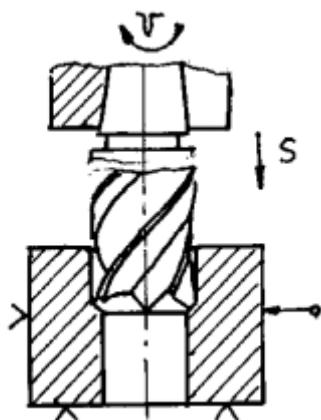
Сверление глухого(сквозного) отверстия спиральным сверлом
