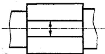
+ на горизонтально-фрезерном станке дисковой фрезой;
