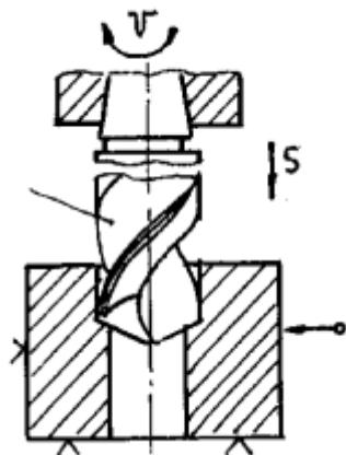
Сверление глухого(сквозного) отверстия спиральным сверлом
