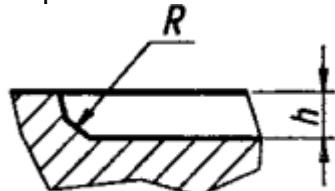
+ на горизонтально-фрезерном станке дисковой фрезой;
