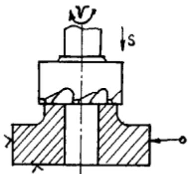
Сверление глухого(сквозного) отверстия спиральным сверлом
