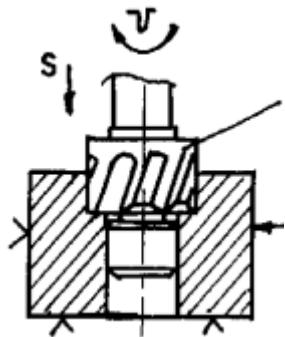
Сверление глухого(сквозного) отверстия спиральным сверлом
