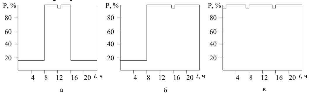
**изображен типовой график активной нагрузки промышленного предприятия, работающего в две смены?**
