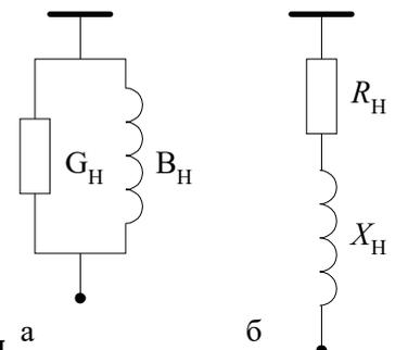
Какую из представленных схем замещения нагрузки удобно использовать для расчета параллельно соединенных элементов?
