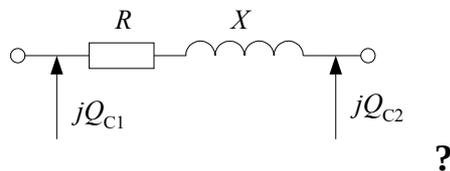
+Схема с рассчитанными зарядными мощностями, в которой не учитывается зависимость зарядной мощности от напряжения
