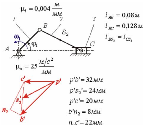
На рисунке показаны план положений и план ускорений кривошипно-ползунного механизма. Ускорение т.  $s_2$  шатуна 2 равно  $\text{m}/\text{s}^2$ :
