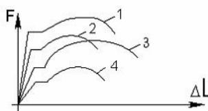
На рисунке показаны диаграммы растяжения четырех образцов из различных пластичных материалов. Наибольшей пластичностью обладает материал образца с диаграммой под номером:
