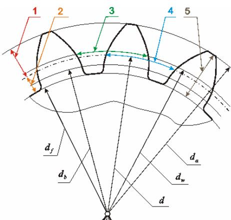
На рисунке изображено прямозубое цилиндрическое эвольвентное зубчатое колесо. Высота зуба обозначена цифрой:
