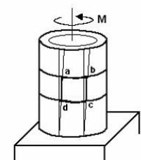
Если к тонкостенной трубе приложен скручивающий момент M , то напряженным состоянием для элементарного объема «abcd» будет:
