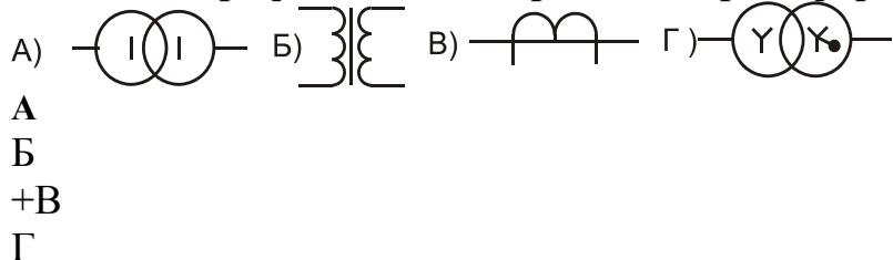
**Условное графическое однолинейное изображение однофазного силового трансформатора:**
