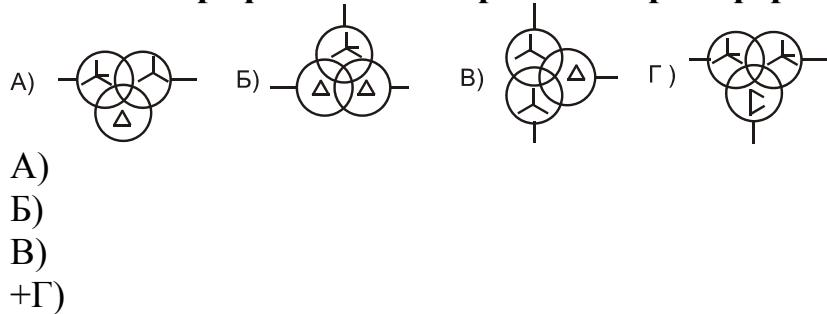
**Условное графическое изображение трансформатора 110/35/10 кВ:**
