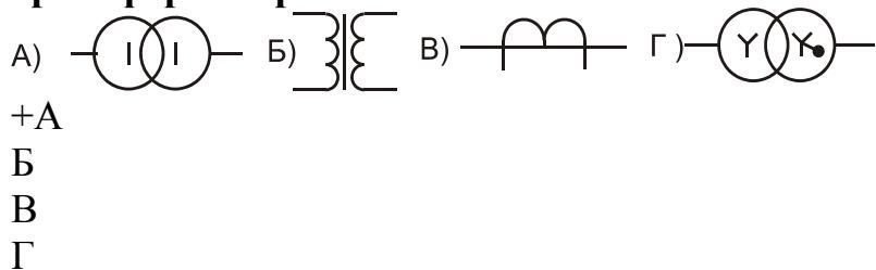
**Условное графическое изображение трансформатора напряжения:**
