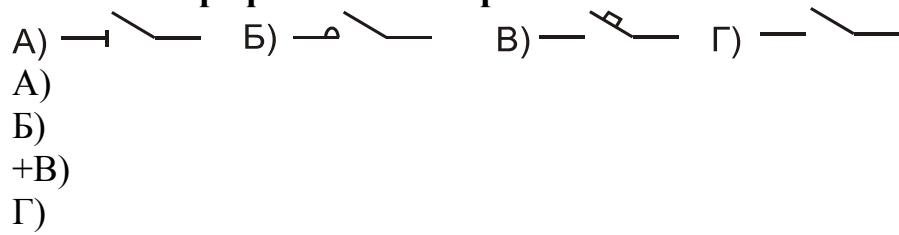
**Изображение вспомогательного контакта магнитного пускателя:**
