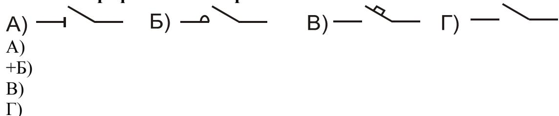
**Условное графическое изображение автоматического выключателя:**
