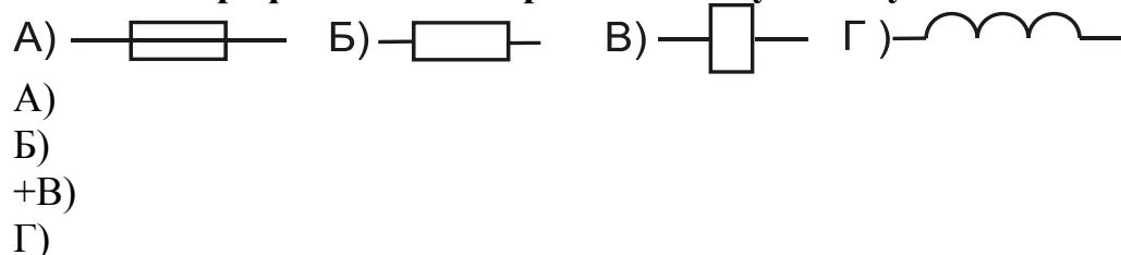
**Условное графическое изображение силового контакта магнитного пускателя:**
