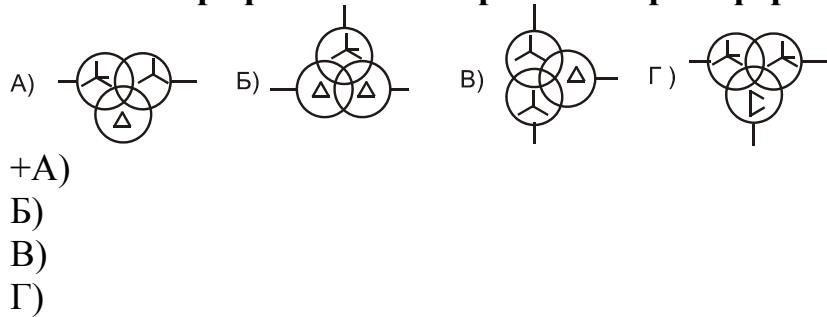
**Условное графическое изображение трансформатора с расщепленной обмоткой:**
