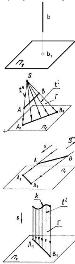
**Параллельное косоугольное проецирование показано на чертеже...**
