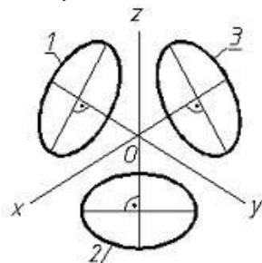
имеет размер малой оси, равный \_\_\_, (где  $d$  – величина диаметра окружности в пространстве).
