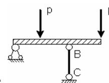
**Если стержень ВС одинаково работает на растяжение и сжатие прочностью проводят по условию...**
