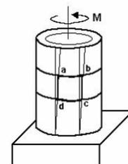
**Если к тонкостенной трубе приложен скручивающий момент  $M$  напряженным состоянием для элементарного объема «abcd» будет...**
