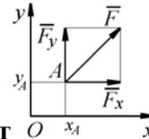
**Определить момент силы относительно начала координат  $O$ , если сила задана проекциями  $F_x = F_y = 210 \text{ Н}$  и известны координаты точки приложения силы**
