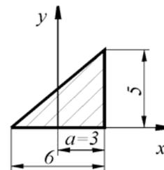
**Определить координату  $x_C$  центра тяжести** **однородной пластины:**
