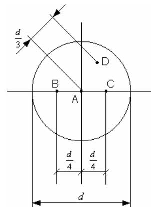
**Стержень скручивается. Максимальные касательные напряжения действуют...**
