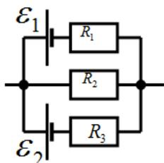
8. Определить силу токов на всех участках электрической цепи , если  $\mathcal{E}_1=10\text{В}$ ,  $\mathcal{E}_2=20\text{В}$ ,  $R_1=4 \text{ Ом}$ ,  $R_2 =5 \text{ Ом}$ ,  $R_3=2 \text{ Ом}$ . Внутреннее сопротивление источников тока  $r =1 \text{ Ом}$  и  $r =2 \text{ Ом}$ .
