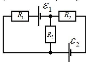
6. Две батареи ( $\epsilon_1=40\text{В}$ ,  $r_1=8\text{Ом}$ ,  $\epsilon_2=20\text{В}$ ,  $r_2=6\text{Ом}$ ) и три сопротивления по  $5\text{Ом}$  каждый соединены, как показано на рис. Определите силу тока в каждом сопротивлении.
