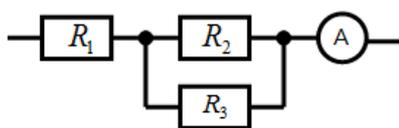
7. Определите напряжение на каждом сопротивлении, если показание амперметра 5 А.
