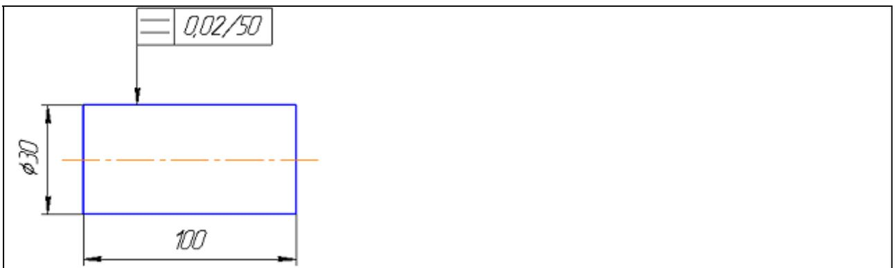
отклонение формы от цилиндричности не должно превышать 0,02 мм на длине 50 мм
