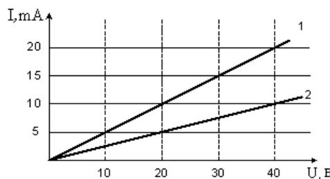
Отношение сопротивлений  $R_1/R_2$  этих элементов равно...
