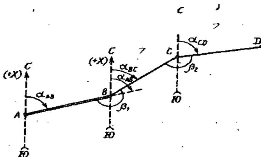
по известным координатам начальной и конечной точек определяют его дирекционный угол и горизонтальное проложение.
