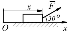
На тело действует постоянная по направлению сила  $F = 4x^3$ . Определить работу этой силы при перемещении тела из положения с координатой  $x_1 = 0$  в положение с координатой  $x_2 = 1 \text{ м}$ .
