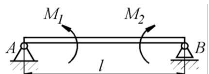
На балку, длина которой  $l = 3 \text{ м}$ , действует пара сил с моментами  $M_1 = 2 \text{ кН} \cdot \text{м}$  и  $M_2 = 8 \text{ кН} \cdot \text{м}$ . Определить в кН модуль реакции опоры В.
