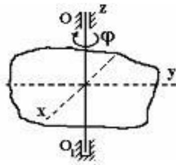
**Твердое тело вращается вокруг неподвижной оси  $O_O_1$  по закону  $\varphi = 40 - 7t$  ( $\varphi$  – в радианах,  $t$  – в секундах). В промежуток времени от  $t = 0$  до  $t = 1$  с тело вращается...**
