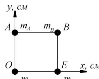
Определить в см координату  $y_C$  центра тяжести квадрата из невесомых стержней с грузами массой  $m_A = 2\text{кг}$ ,  $m_B = 3\text{кг}$ ,  $m_O = 1\text{кг}$ ,  $m_E = 4\text{кг}$ , если  $AO = OE = 30\text{см}$ .
