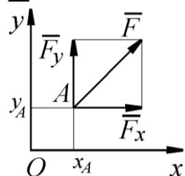
**Определить момент силы относительно начала координат, если сила задана проекциями  $F_x = F_y = 210 \text{ H}$  и известны координаты точки приложения силы  $x_A = y_A = 0,1 \text{ m}$ :**
