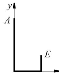
Определить в см координату  $y_C$  центра тяжести кронштейна  $B$ , состоящего из однородных стержней  $AB = 0,2\text{м}$ ,  $BD = 0,1\text{м}$  и  $DE = 0,06\text{м}$ , имеющих одинаковый линейный вес.
