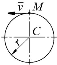
ростью  $v = 4 \text{ м/с}$ . Определить момент количества движения точки относительно центра С окружности радиуса  $r = 0,5 \text{ м}$ .
