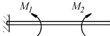
Консольная балка нагружена парами сил с моментами  $M_1 = 1790 \text{ Н} \cdot \text{м}$  и  $M_2 = 2135 \text{ Н} \cdot \text{м}$ . Определить момент в заделке.
