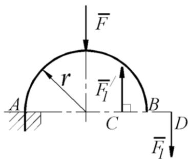
1. На арку АВ действует пара сил ( $F_1$ ,  $F_1'$ ) и сила  $\bar{F}$ . Определить сумму их моментов относительно точки А, если силы  $F = 4 \text{ H}$ ,  $F_1 = 2 \text{ H}$ , радиус  $r = 2 \text{ м}$ , плечо  $CD = 1,5 \text{ м}$ :
