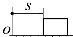
**Тело массой  $m = 2$  кг движется по горизонтальным направляющим согласно закону  $s = 2t^2 + 1$ . Определить модуль главного вектора внешних сил, действующих на тело.**
