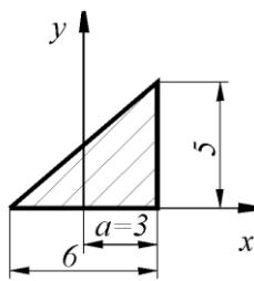
Определить координату  $x_C$  центра тяжести однородной пластины...
