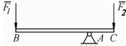
**На брус BC, закрепленный в шарнире A вертикальные силы  $F_1 = 4 \text{ kH}$  и  $F_2$ . Определить силу  $F_2$  в кН, необходимую для того, чтобы брус в положении равновесия был горизонтальным, если расстояния  $AC = 2 \text{ м}$ ,  $AB = 6 \text{ м}$ .**
