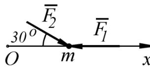
**Материальная точка массой  $m = 5 \text{ кг}$**  движется под действием сил  $F_1 = 3 \text{ Н}$  и  $F_2 = 10 \text{ Н}$ . Определить проекцию ускорения точки на ось  $Ox$ .
