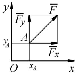
1. Определить момент силы относительно начала координат, если сила задана проекциями  $F_x = F_y = 210 \text{ H}$  и известны координаты точки приложения силы  $x_A = y_A = 0,1 \text{ м}$ :
