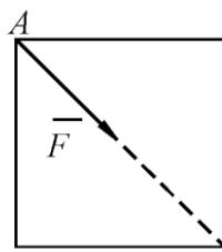
К вершине А квадратной пластины  $B$ , длины сторон которой равны 0,2 м, приложена сила  $F = 150 \text{ H}$ . Определить момент этой силы относительно точки В.
