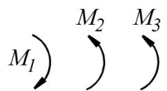
**В одной плоскости расположены три пары сил пары сил  $M_3$ , при котором эта система находится в равновесии, если моменты**
