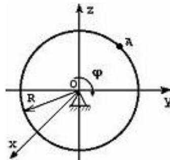
**Тело радиуса  $R = 10$  см вращается вокруг оси  $OX$  по закону  $\varphi = 40 + 2t^2$  ( $\varphi$  – в радианах,  $t$  – в секундах). Скорость точки  $A$  при  $t = 2$  с будет равна...**
