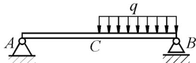
**На однородную балку AB действует распределенная нагрузка интенсивностью  $q = 0,5 \text{ кН/m}$ . Определить в кН реакцию опоры A, если длины  $AB = 6 \text{ м}$ ,  $AC = BC$ .**
