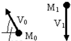
На рисунке показаны начальное и конечное положения точки массой  $m = 2 \text{ кг}$ , при этом  $V_0 = 5 \text{ м/с}$ ,  $V_1 = 10 \text{ м/с}$ . Проекция на ось  $x$ , импульса силы действующей на точку, за рассматриваемый промежуток времени (с точностью до 0,1) равна:
