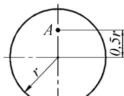
**Определить угловую скорость колеса**, если точка А имеет скорость  $v_A = 10 \text{ м/с}$ , радиус колеса  $r = 0,2 \text{ м}$ . (с точностью до 0,1):
