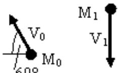
На рисунке показаны начальное и конечное положения точки массой  $m = 2 \text{ кг}$ , при этом  $V_0 = 5 \text{ м/с}$ ,  $V_1 = 10 \text{ м/с}$ . Проекция на ось  $y$ , импульса силы действующей на точку, за рассматриваемый промежуток времени (с точностью до 0,1) равна:
