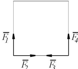
**. Определить модуль равнодействующей этой системы сил.**
