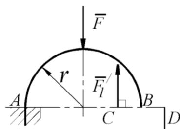
На арку АВ действует пара сил  $(\bar{F}_1, \bar{F}'_1)$  и сила  $\bar{F}$ . Определить сумму их моментов относительно точки А, если силы  $F = 4 \text{ H}$ ,  $F_1 = 2 \text{ H}$ , радиус  $r = 2 \text{ м}$ , плечо  $CD = 1,5 \text{ м}$ :
