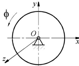
Диск вращается вокруг оси Oz по закону  $\phi = t^3$ . Определить модуль момента пары сил, приложенной к диску, в момент времени  $t = 1 \text{ с}$ , если момент инерции диска относительно оси вращения равен  $2 \text{ кг} \cdot \text{м}^2$ .
