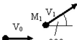
На рисунке показаны начальное и конечное положения точки массой  $m = 2 \text{ кг}$ , при этом  $V_0 = 5 \text{ м/с}$ ,  $V_1 = 10 \text{ м/с}$ . Проекция на ось  $y$ , импульса силы действующей на точку, за рассматриваемый промежуток времени (с точностью до 0,1) равна:
