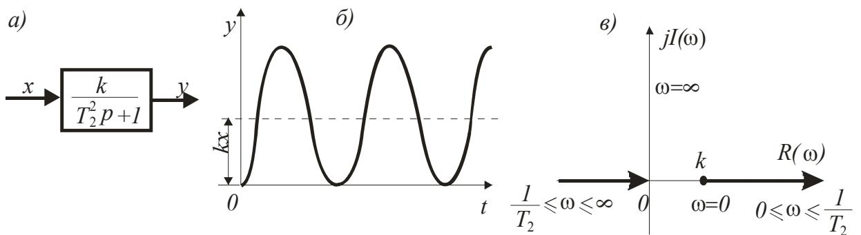
*Правильный ответ: Гармоническое колебательное звено* – описывается уравнением  $(T_2^2 p^2 + 1)y = kx$ . Если при колебаниях отсутствуют потери энергии в звене, то его называют гармоническим колебательным (консервативным).
