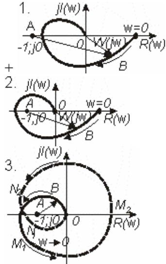
АФЧХ разомкнутой системы  $W(j\omega)$  отличается от АФЧХ замкнутой системы  $T(j\omega)=1+W(j\omega)$  сдвигом на единицу:
