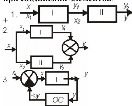
Коэффициент передачи (усиления) системы, состоящей из  $n$  последовательно соединенных элементов, равен:
