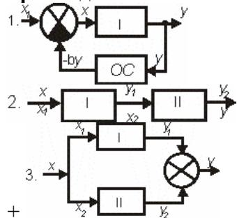
Коэффициент передачи (усиления) системы, состоящей из  $n$  параллельно соединенных элементов, равен:
