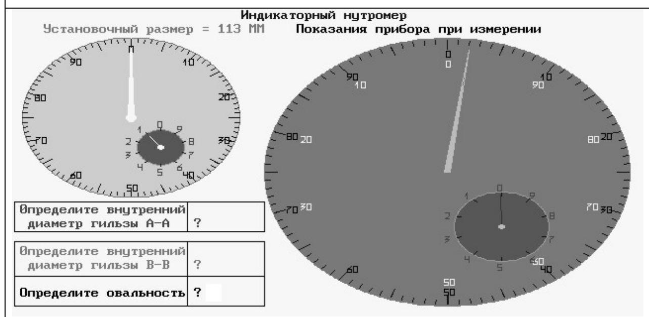
1.  $c=1$  мм,      диапазон измерения 0 – 1 мм
