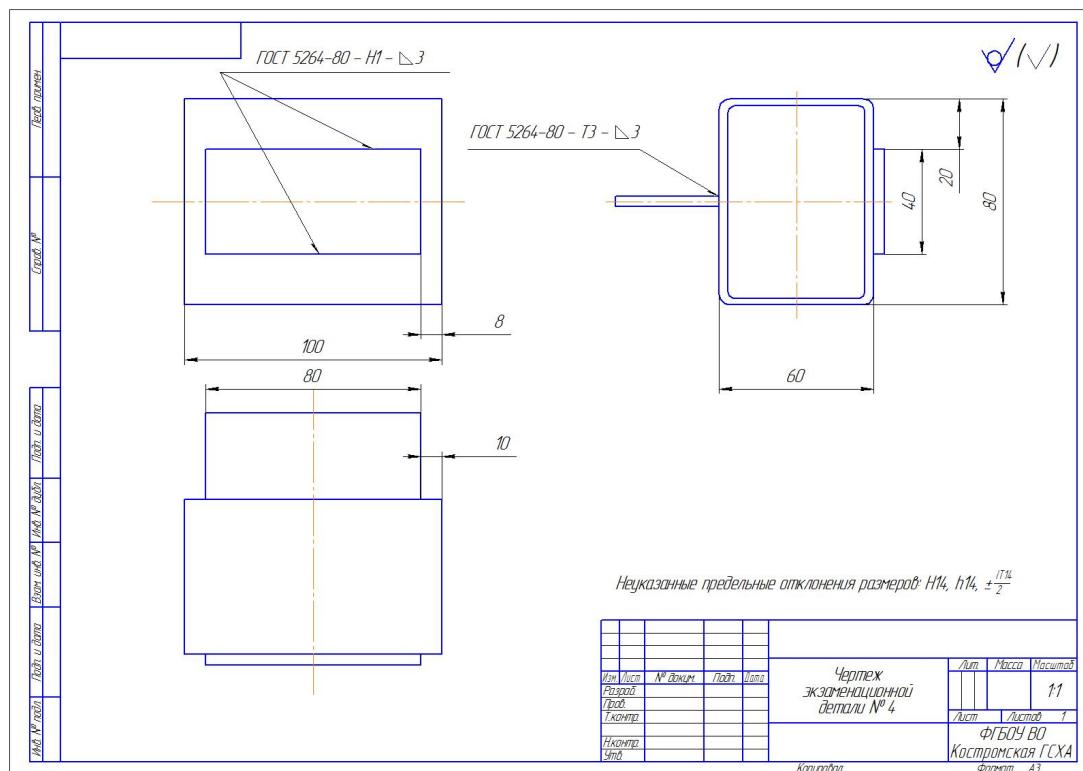
4. Проконтролируйте готовое сварное изделие: визуальный и измерительный метод контроля.
