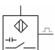
На рисунке изображен трехпроводный датчик электронного типа:
