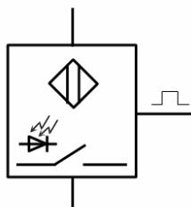
На рисунке изображен трехпроводный датчик электронного типа:
