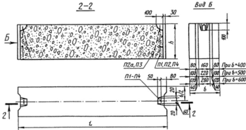
+блоки бетонные для стен подвалов
