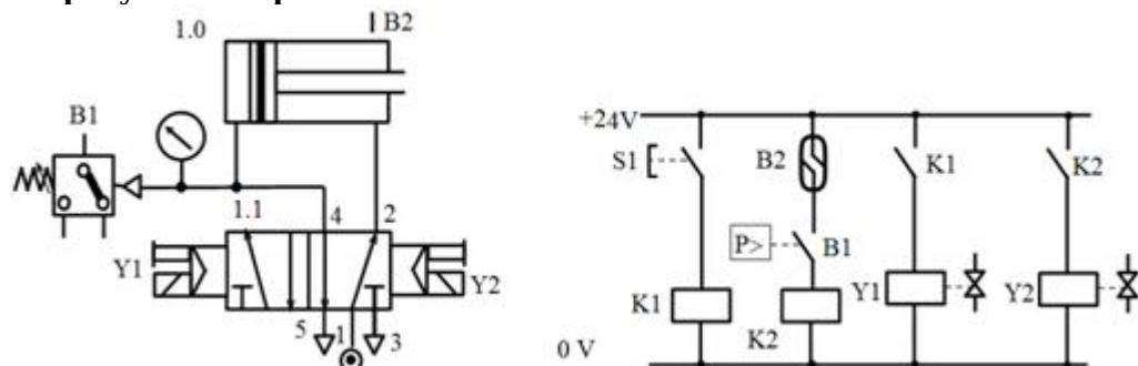
управления движением штока цилиндра двустороннего действия с использованием бистабильного 5/2 пневмораспределителя
