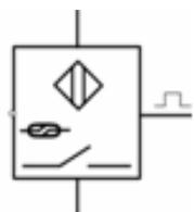
На рисунке изображен трехпроводный датчик электронного типа:
