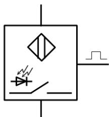
На рисунке изображен трехпроводный датчик электронного типа:
