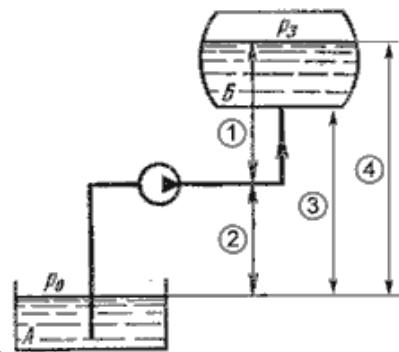
Геометрическая высота нагнетания на рисунке обозначена позицией:
