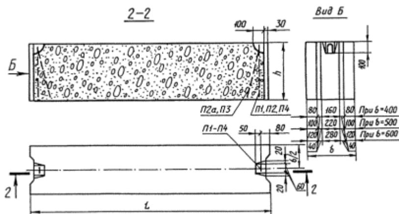
+блоки бетонные для стен подвалов
