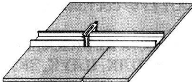
подвесной потолок по деревянному каркасу из брусков прямоугольного сечения с закрепленными на нем гипсокартонными, гипсоволокнистыми листами
