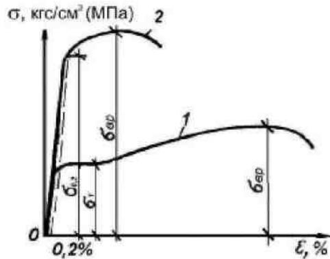
характеристикам работы на разрыв образца стали
