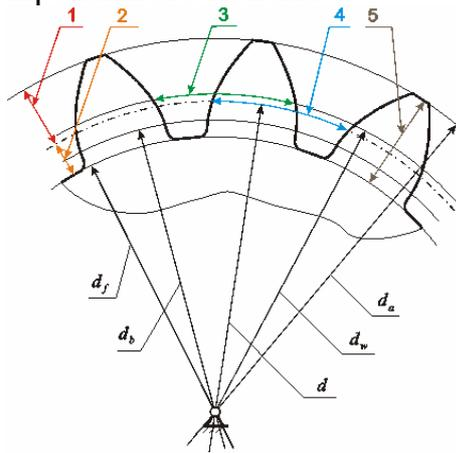
На рисунке изображено прямозубое цилиндрическое эвольвентное зубчатое колесо. Делительный окружной шаг зубьев обозначен цифрой...
