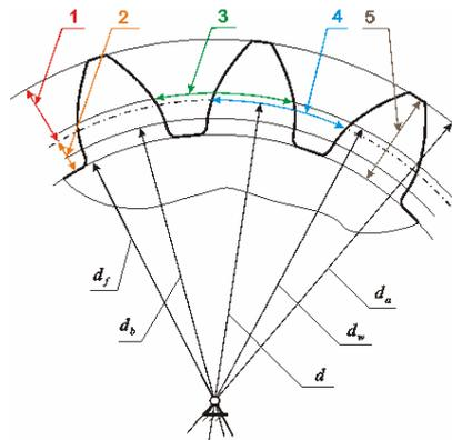
На рисунке изображено прямозубое цилиндрическое эвольвентное зубчатое колесо. Высота делительной головки зуба обозначена цифрой ...
