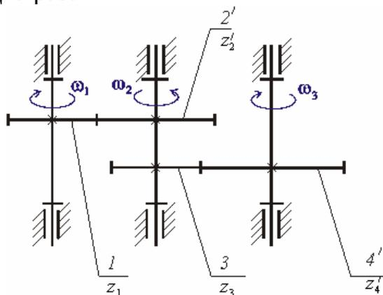
На рисунке приведена структурная схема многоступенчатой зубчатой передачи. Если число зубьев зубчатого колеса 1  $z_1$  увеличить в два раза, то угловая скорость  $\omega_3$  ...
