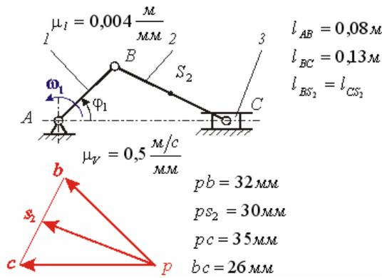
На рисунке показаны план положений и план скоростей кривошипно-ползунного механизма. Угловая скорость шатуна 2 равна рад/с:
