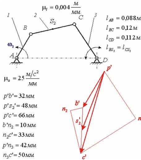
На рисунке показаны план положений и план ускорений шарнирного четырехзвенного механизма. Угловое ускорение шатуна 2 равно  $\text{рад/с}^2$ :
