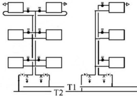
**водяную систему отопления:**
