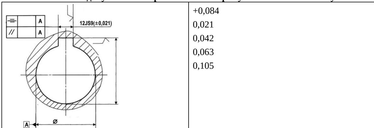
Укажите значение допуска параллельности на ширину шпоночного паза втулки
