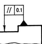
+допуск параллельности поверхностей равен 0,1 мм.
