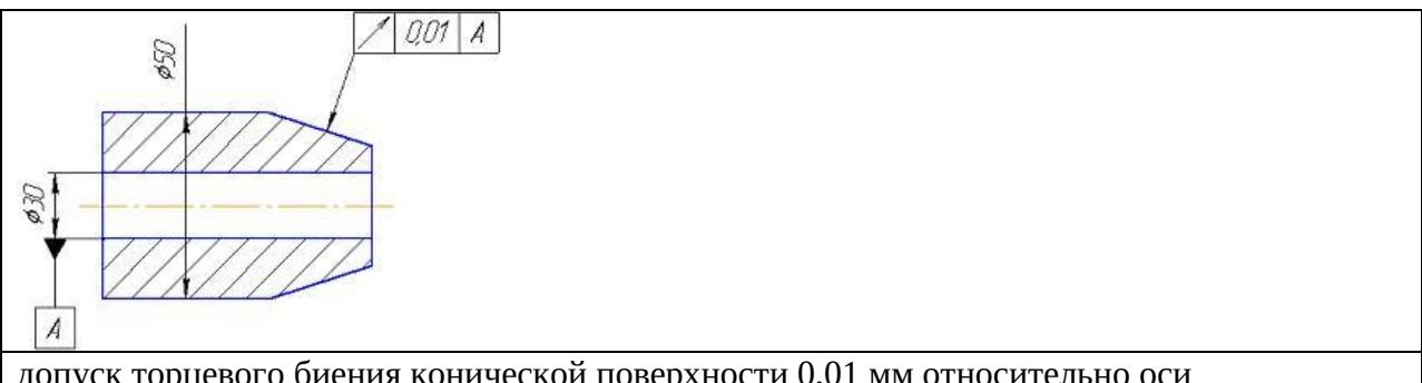
допуск торцевого биения конической поверхности 0,01 мм относительно оси отверстия  $\varnothing 30$  мм
