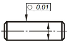
допуск и отклонение от цилиндричности
