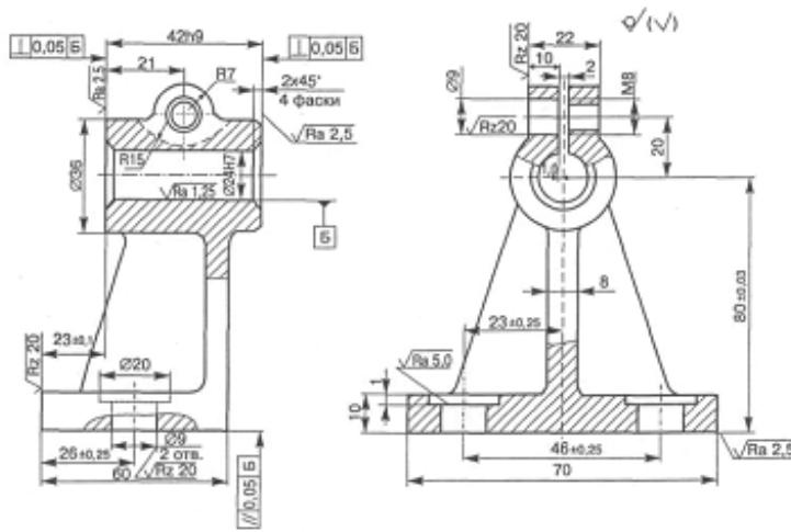
1. Цементировать  $h 1,0 \dots 1,4$  мм;  $HRC_58 \dots 65$ , сердцевина —  $HRC_35 \dots 45$
