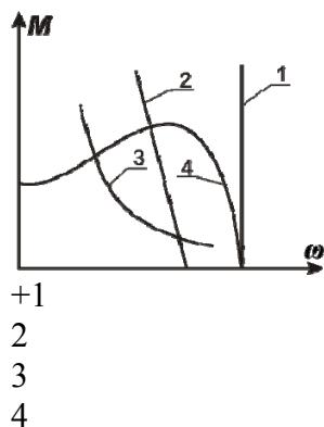
**Механическая характеристика синхронной машины:**
