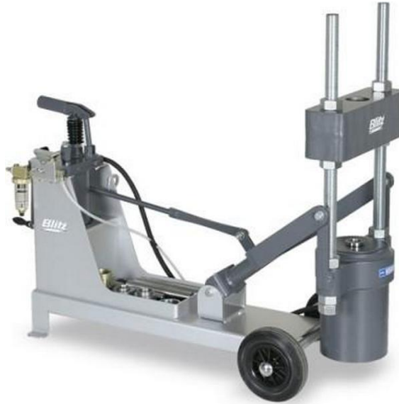
СТЕНД ДЛЯ ВЫПРЕССОВКИ ШКВОРНЕЙ (усилие 40000 кг)
