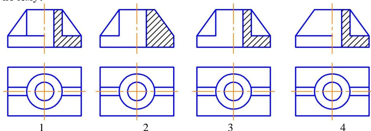
*Правильный ответ:* соединение вида с разрезом выполнено правильно на рисунке 1, так как ребро жесткости изображается на разрезе рассеченным, но не заштриховывается.
