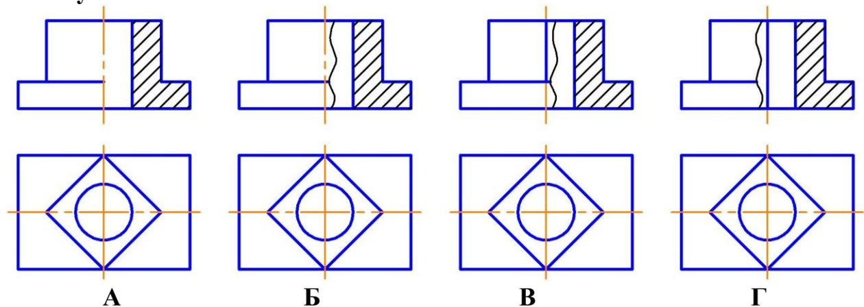
*Правильный ответ:* соединение вида с разрезом выполнено правильно на рисунке В, так как сплошная волнистая линия разделяет вид и разрез, а на осевую линию проецируется линия видимого контура
