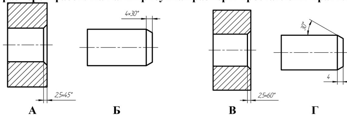
*Правильный ответ:* если фаска срезана под углом 45градусов, то размер проставляется по типу  $2 \times 45^\circ$ , если под другим углом, то линейный и угловой размеры проставляются раздельно. Верно проставлены размеры на рисунках А и Г.
