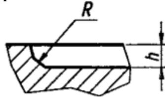
+ на горизонтально-фрезерном станке дисковой фрезой;
