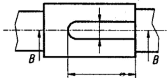
на горизонтально-фрезерном станке дисковой фрезой;
