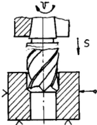
Сверление глухого(сквозного) отверстия спиральным сверлом
