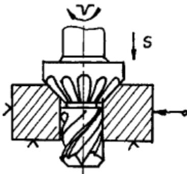
Сверление глухого(сквозного) отверстия спиральным сверлом
