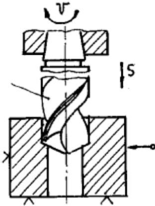
Сверление глухого(сквозного) отверстия спиральным сверлом
