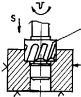
Сверление глухого(сквозного) отверстия спиральным сверлом
