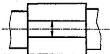
+ на горизонтально-фрезерном станке дисковой фрезой;
