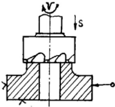
Сверление глухого(сквозного) отверстия спиральным сверлом
