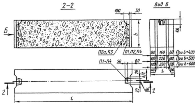
+блоки бетонные для стен подвалов
