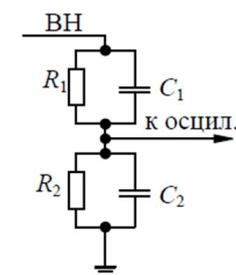
**На какой из схем изображен емкостно-омический делитель напряжения?**
