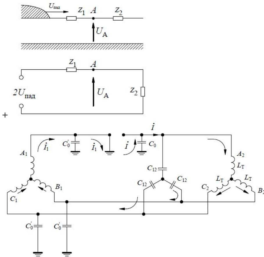
**Какие перенапряжения возникают в резонансных контурах, образующихся в сетях с изолированной нейтралью, если к линии подключены малонагруженные трансформаторы?**
