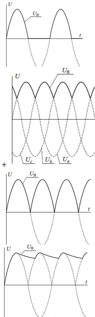
**Наличие фильтра в однополупериодной схеме выпрямления:**
