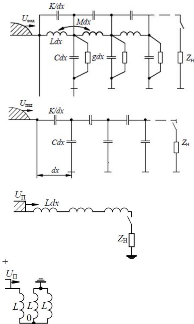
**Для трансформаторов с заземленной нейтралью главная изоляция должна быть усилена:**
