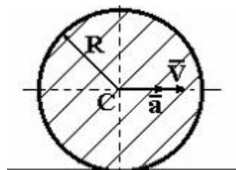
Однородный диск радиуса  $R$  и массы  $m$  катится по горизонтальной плоскости, имея в точке  $C$  скорость  $\vec{V}$  и ускорение  $\vec{a}$ . Кинетическая энергия диска равна:
