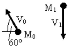
На рисунке  $M_0$  показаны начальное и конечное положения точки массой  $m = 2 \text{ кг}$ , при этом  $V_0 = 5 \text{ м/с}$ ,  $V_1 = 10 \text{ м/с}$ . Проекция на ось  $x$  импульса силы, действующей на точку, за рассматриваемый промежуток времени (с точностью до 0,1) равна:
