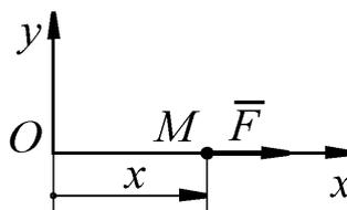
Материальная точка массой  $m$  движется по горизонтальной оси  $Ox$  под действием силы  $F = 2m(x + 1)$ . Определить ускорение точки в момент времени, когда её координата  $x = 0,5 \text{ м}$ .
