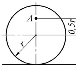
**Определить угловую скорость колеса** , **если точка А имеет скорость  $v_A = 10 \text{ м/с}$ , радиус колеса  $r = 0,2 \text{ м}$  (с точностью до 0,1):**
