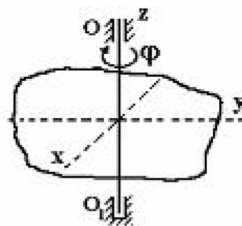
**Твердое тело вращается вокруг неподвижной оси  $OO_1$**
