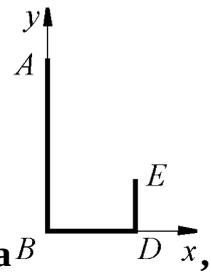
Определить в см координату  $y_C$  центра тяжести кронштейна состоящего из однородных стержней  $AB = 0,2\text{м}$ ,  $BD = 0,1\text{м}$  и  $DE = 0,06\text{м}$ , имеющих одинаковый линейный вес.
