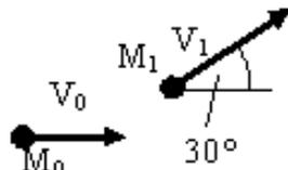
показаны начальное и конечное положения точки массой  $m = 2 \text{ кг}$ , при этом  $V_0 = 5 \text{ м/с}$ ,  $V_1 = 10 \text{ м/с}$ . Проекция на ось  $y$  импульса силы, действующей на точку, за рассматриваемый промежуток времени (с точностью до 0,1) равна:
