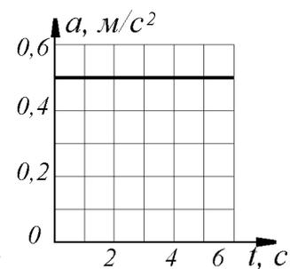
Точка движется по прямой. Дан график ускорения  $a = f(t)$ . Определить скорость точки в момент времени  $t = 6$  с, если при  $t_0 = 0$ ,  $v_0 = 0$ .
