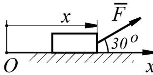
работу этой силы  $O$  при перемещении тела из положения с координатой  $x_1 = 0$  в положение с координатой  $x_2 = 1$  м.
