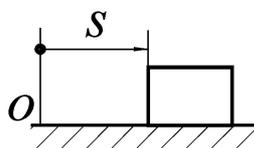
Тело массой  $m = 2$  кг движется по горизонтальным направляющим согласно закону  $s = 2t^2 + 1$ . Определить модуль главного вектора внешних сил, действующих на тело.
