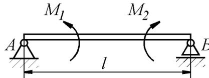
На балку, длина которой  $l = 3 \text{ м}$ , действует пара сил с моментами  $M_1 = 2 \text{ кН} \cdot \text{м}$  и  $M_2 = 8 \text{ кН} \cdot \text{м}$ . Определить в кН модуль реакции опоры В.
