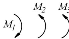
4. В одной плоскости расположены три пары сил  $M_1$ ,  $M_2$ ,  $M_3$ . Определить момент пары сил  $M_3$ , при котором эта система находится в равновесии, если моменты  $M_1 = 510 \text{ Н} \cdot \text{м}$ ,  $M_2 = 120 \text{ Н} \cdot \text{м}$ .
