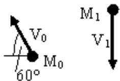
На рисунке показаны начальное и конечное положения точки массой  $m = 2 \text{ кг}$ , при этом  $V_0 = 5 \text{ м/с}$ ,  $V_1 = 10 \text{ м/с}$ . Проекция на ось  $y$  импульса силы, действующей на точку, за рассматриваемый промежуток времени (с точностью до 0,1) равна:
