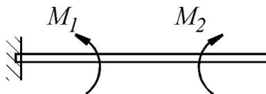
Консольная балка нагружена парами сил с моментами  $M_1 = 1790 \text{ Н} \cdot \text{м}$  и  $M_2 = 2135 \text{ Н} \cdot \text{м}$ . Определить момент в заделке.
