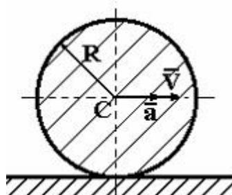
Однородный диск радиуса  $R$  и массы  $m$  катится по горизонтальной плоскости, имея в точке  $C$  скорость  $\bar{V}$  и ускорение  $a$ . Количество движения диска равно:
