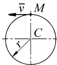
Материальная точка  $M$  массой  $m = 1 \text{ кг}$  движется равномерно по окружности со скоростью  $v = 4 \text{ м} / \text{с}$ . Определить момент количества движения точки относительно центра  $C$  окружности радиуса  $r = 0,5 \text{ м}$ .
