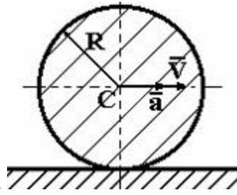
Однородный диск радиуса  $R$  и массы  $m$  катится по горизонтальной плоскости, имея в точке  $C$  скорость  $\vec{V}$  и ускорение  $\vec{a}$ . Кинетический момент диска относительно оси, перпендикулярной плоскости диска и проходящей через его центр, равен:
