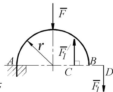
На арке АВ действует пара сил  $(\vec{F}_1, \vec{F}_1')$  и сила  $\vec{F}$ .
