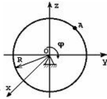
**Тело радиуса  $R = 10 \text{ см}$  вращается вокруг оси  $OX$  по закону  $\varphi = 40 + 2t^2$  ( $\varphi$  - в радианах,  $t$  – в секундах). Скорость точки  $A$  при  $t = 2 \text{ с}$  будет равна:**
