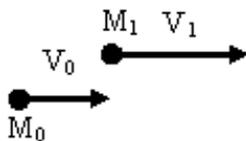
На рисунке  $M_0$  показаны начальное и конечное положения точки массой  $m = 2 \text{ кг}$ , при этом  $V_0 = 5 \text{ м/с}$ ,  $V_1 = 10 \text{ м/с}$ . Проекция на ось  $x$  импульса силы, действующей на точку, за рассматриваемый промежуток времени (с точностью до 0,1) равна:
