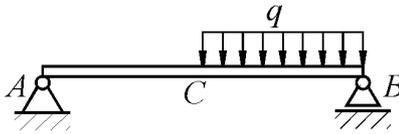
На однородную балку АВ, вес которой  $G = 20 \text{ кН}$ , действует распределенная нагрузка интенсивностью  $q = 0,5 \text{ кН/м}$ . Определить в кН реакцию опоры А, если длины  $AB = 6 \text{ м}$ ,  $AC = BC$ .
