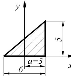
Определить координату  $x_C$  центра тяжести однородной пластины:
