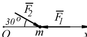
Материальная точка массой  $m = 5 \text{ кг}$  движется под действием сил  $F_1 = 3 \text{ Н}$  и  $F_2 = 10 \text{ Н}$ . Определить проекцию ускорения точки на ось  $Ox$ .
