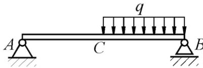
На однородную балку AB, вес которой  $G = 20 \text{ кН}$ , действует распределенная нагрузка интенсивностью  $q = 0,5 \text{ кН/м}$ . Определить в кН реакцию опоры A, если длины  $AB = 6 \text{ м}$ ,  $AC = BC$ .
