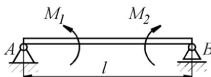
На балку, длина которой  $l = 3 \text{ м}$ , действует пара сил с моментами  $M_1 = 2 \text{ кН} \cdot \text{м}$  и  $M_2 = 8 \text{ кН} \cdot \text{м}$ . Определить в кН модуль реакции опоры B.
