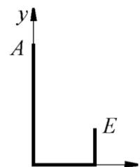
Определить в см координату  $y_C$  центра тяжести кронштейна  $B$   $D$ , состоящего из однородных стержней  $AB = 0,2\text{ м}$ ,  $BD = 0,1\text{ м}$  и  $DE = 0,06\text{ м}$ , имеющих одинаковый линейный вес.
