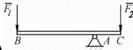
На брус BC, закрепленный в шарнире A, действуют вертикальные силы  $F_1 = 4 \text{ кН}$  и  $F_2$ . Определить силу  $F_2$  в кН, необходимую для того, чтобы брус в положении равновесия был горизонтальным, если расстояния  $AC = 2 \text{ м}$ ,  $AB = 6 \text{ м}$ .
