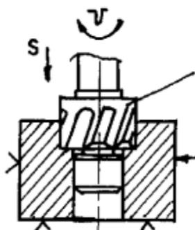
Сверление глухого(сквозного) отверстия спиральным сверлом
