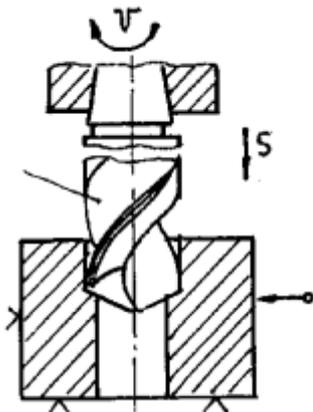
Сверление глухого(сквозного) отверстия спиральным сверлом
