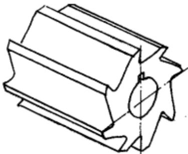
цилиндрическая фреза с прямым зубом;
