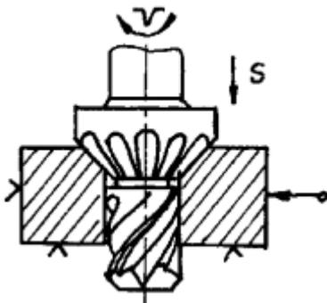
Сверление глухого(сквозного) отверстия спиральным сверлом
