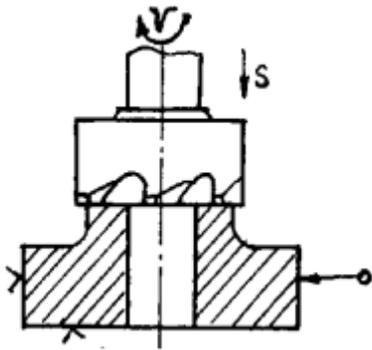
Сверление глухого(сквозного) отверстия спиральным сверлом
