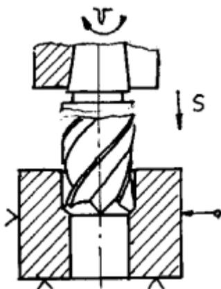
Сверление глухого(сквозного) отверстия спиральным сверлом
