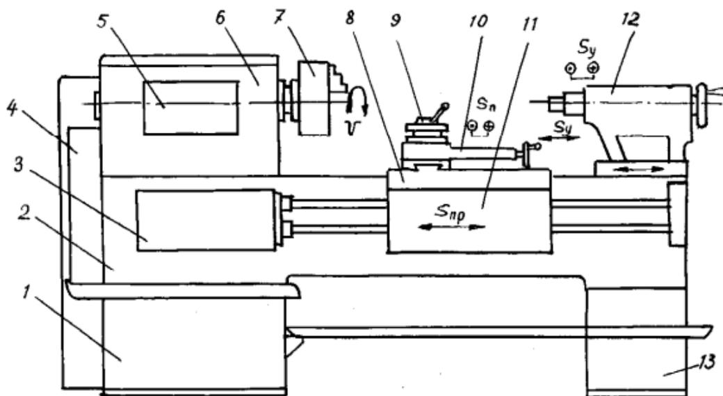
передняя тумба (с электродвигателем главного привода станка);
