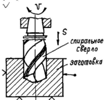
+ Сверление глухого(сквозного) отверстия спиральным сверлом
