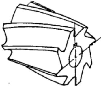
цилиндрическая фреза с прямым зубом;
