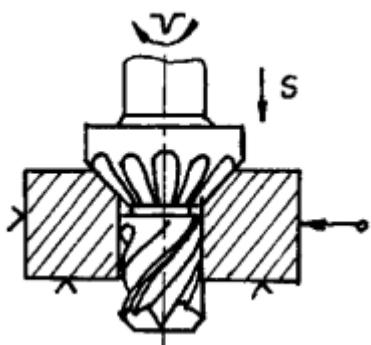
Сверление глухого(сквозного) отверстия спиральным сверлом
