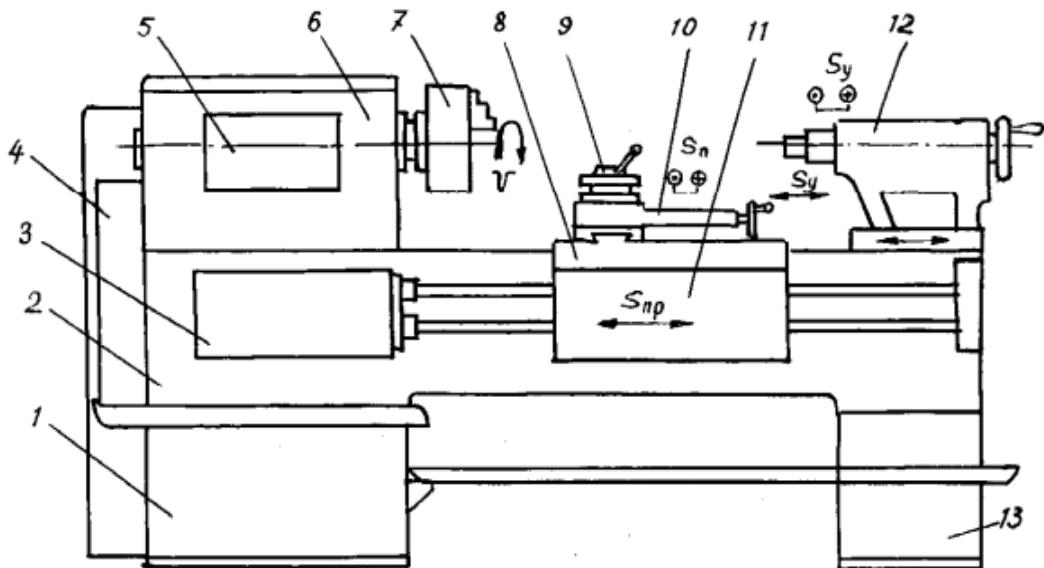
передняя тумба (с электродвигателем главного привода станка);
