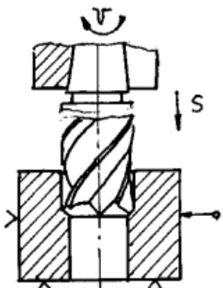
Сверление глухого(сквозного) отверстия спиральным сверлом
