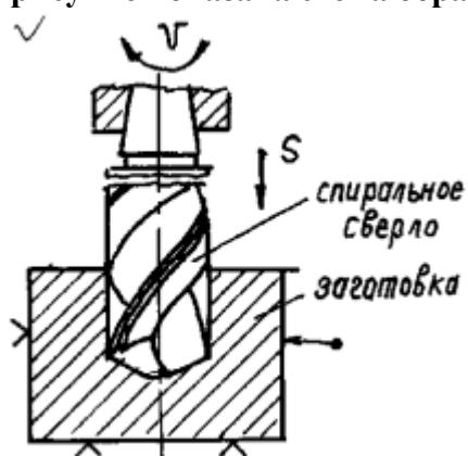
+ Сверление глухого(сквозного) отверстия спиральным сверлом
