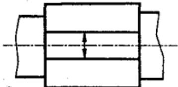
+ на горизонтально-фрезерном станке дисковой фрезой;
