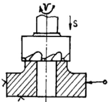
Сверление глухого(сквозного) отверстия спиральным сверлом
