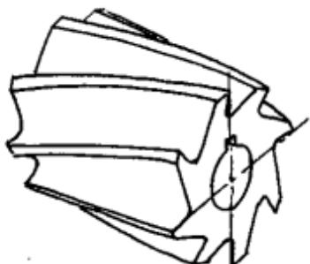
цилиндрическая фреза с прямым зубом;
