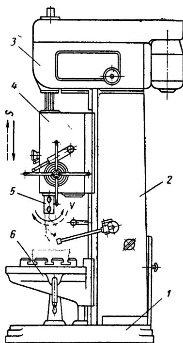
+ вертикально сверлильного станка
