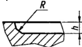
+ на горизонтально-фрезерном станке дисковой фрезой;
