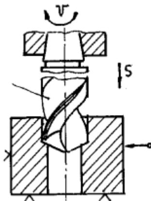
Сверление глухого(сквозного) отверстия спиральным сверлом
