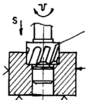
Сверление глухого(сквозного) отверстия спиральным сверлом
