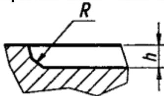
+ на горизонтально-фрезерном станке дисковой фрезой;
