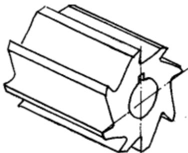
цилиндрическая фреза с прямым зубом;
