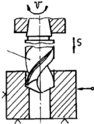
Сверление глухого(сквозного) отверстия спиральным сверлом
