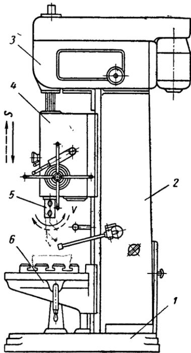
+ вертикально сверлильного станка
