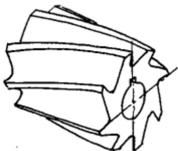
цилиндрическая фреза с прямым зубом;
