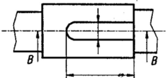
на горизонтально-фрезерном станке дисковой фрезой;
