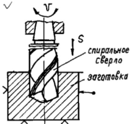
+ Сверление глухого(сквозного) отверстия спиральным сверлом
