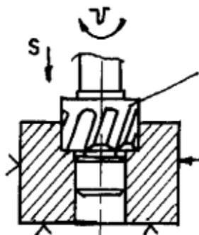
Сверление глухого(сквозного) отверстия спиральным сверлом
