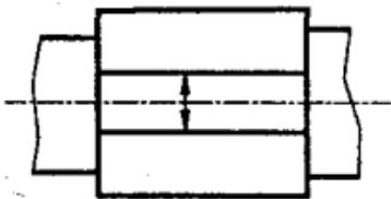
+ на горизонтально-фрезерном станке дисковой фрезой;
