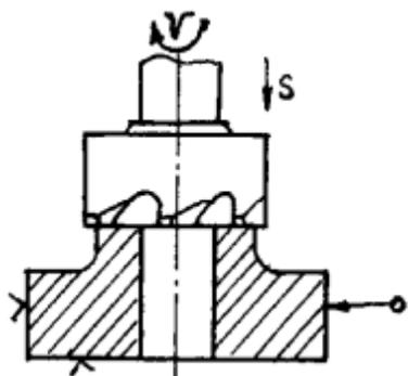
Сверление глухого(сквозного) отверстия спиральным сверлом
