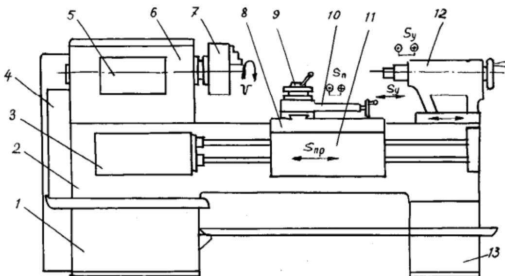
передняя тумба (с электродвигателем главного привода станка);
