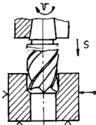
Сверление глухого(сквозного) отверстия спиральным сверлом
