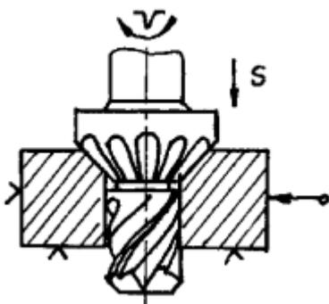
Сверление глухого(сквозного) отверстия спиральным сверлом
